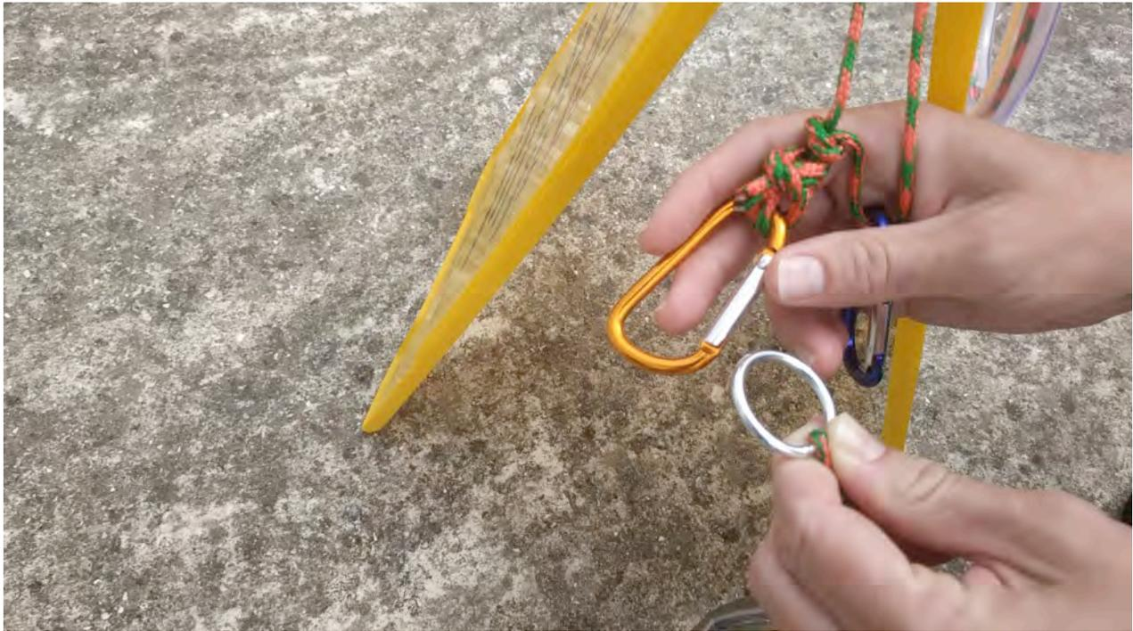
Pour fixer le lest au système d'attache du chevalet de signalisation, veuillez passer l'anneau du lest dans le gros mousqueton fixe. Le lest doit être posé à plat comme sur la photo du bas. Et le système est réglé d'origine pour être légèrement en tension.
