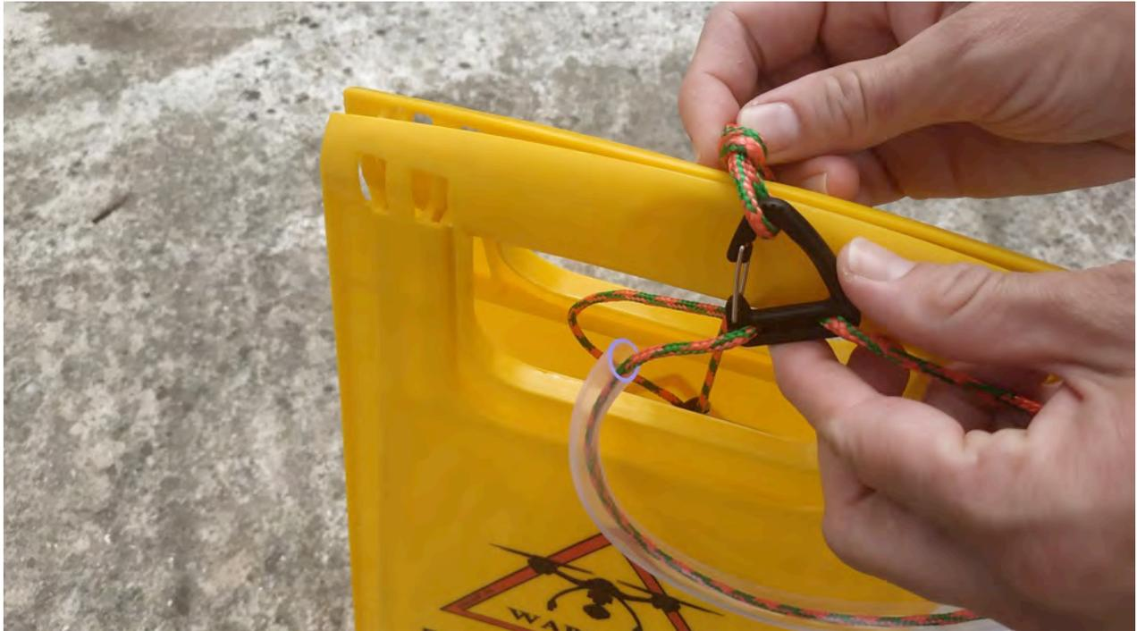
Le mousqueton une fois fermé permet de solidariser le système sur le haut de la poignée du chevalet de signalisation. Vous n'aurez ensuite plus besoin de le désolidariser du chevalet de signalisation. Le système sera transporté et stocké avec.
